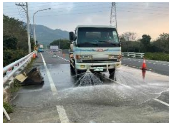
道路清潔水車道路清洗
